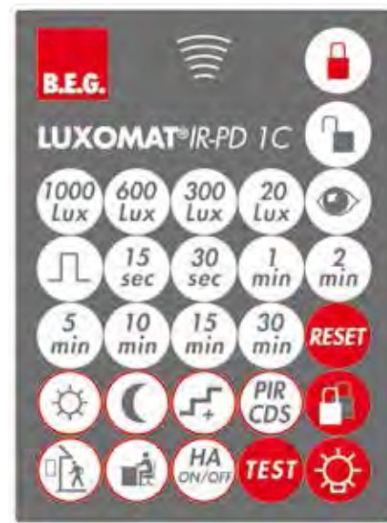
Abbildung 6.7: Fernsteuerung zur Einstellung eines kombinierten Tageslichtpräsenz- sensors. (Quelle: Swisslux)
