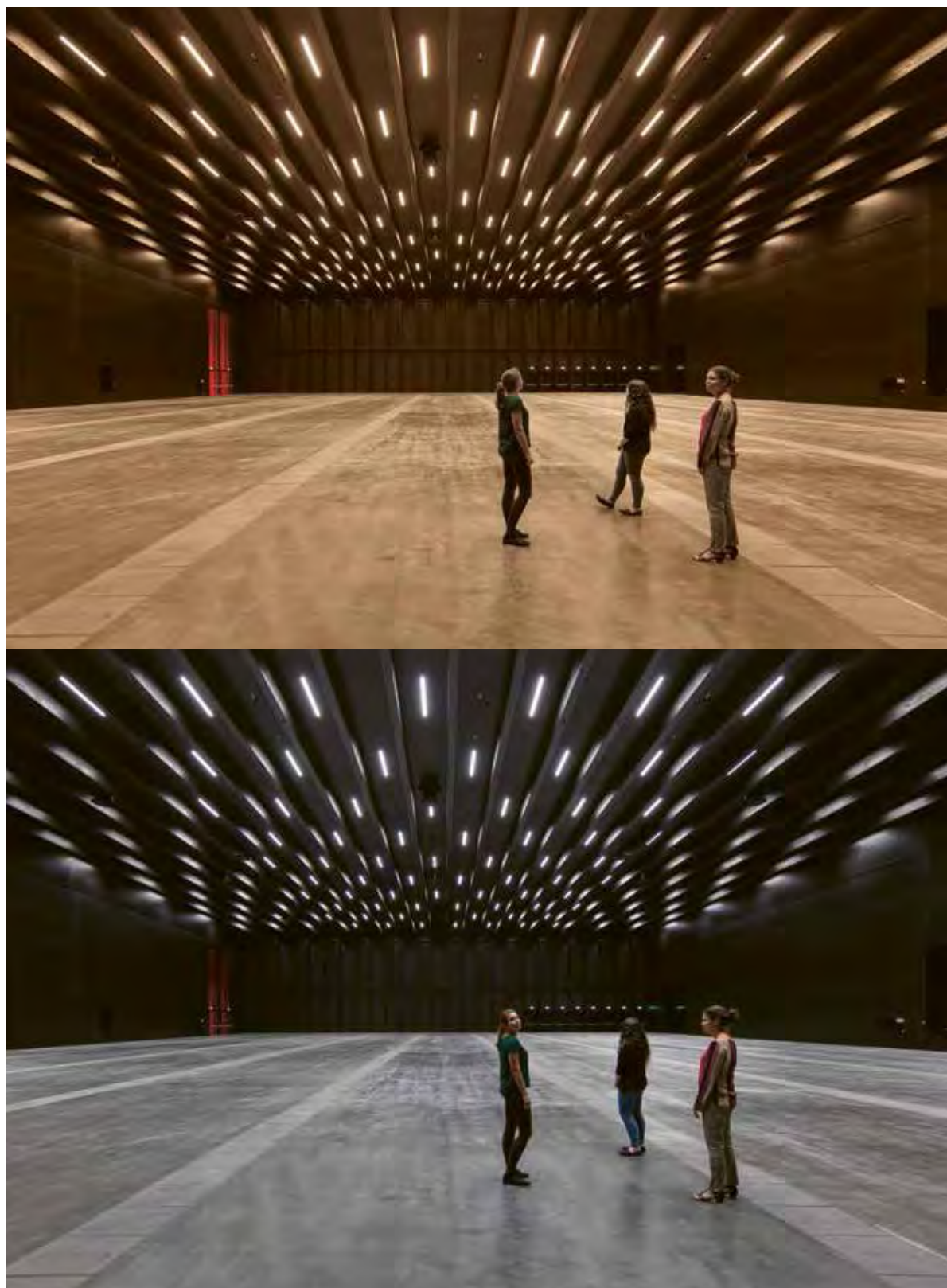
Abbildung 8.22: Das Lichtkonzept ermöglicht eine An- passung der Licht- farbe an den jewei- ligen Event. (Quelle: Faruk Pinjo)
